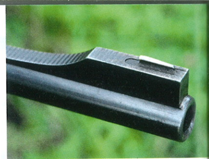
Kornfoten är stilren. Rampen tar effektivt bort alla reflexer. Pärilkornet i silver fångar ljuset effektivt.
