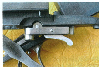
Avfyringsmekanismen är modifierad för att fungera ihop med snälltrycket. Den korta stummen är normalt avtryckaren.
