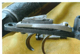
Mekanismen till snälltrycket sitter fast på underbeslaget och fungerar som ett dubbelavtryck som utlöser det ordinarie trycket.
