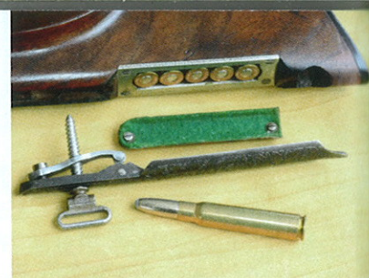
Kolvmagasinet är enkelt och mycket funktionellt. Det är bakre remfästet som håller det på plats i kolven. Observera att filtskyddet på luckans insida hålls på plats av två små skruvar.
