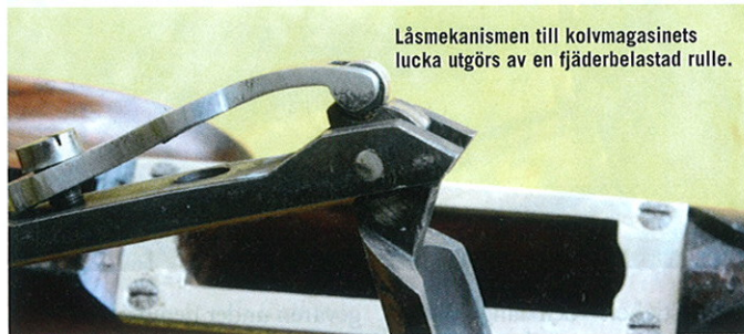
Utmärkande för modell 98 är att den har en tredje rekyllack långt bak på slutstycket. Mekanismen har kontrollerad matning och en icke roterande utdragare.
