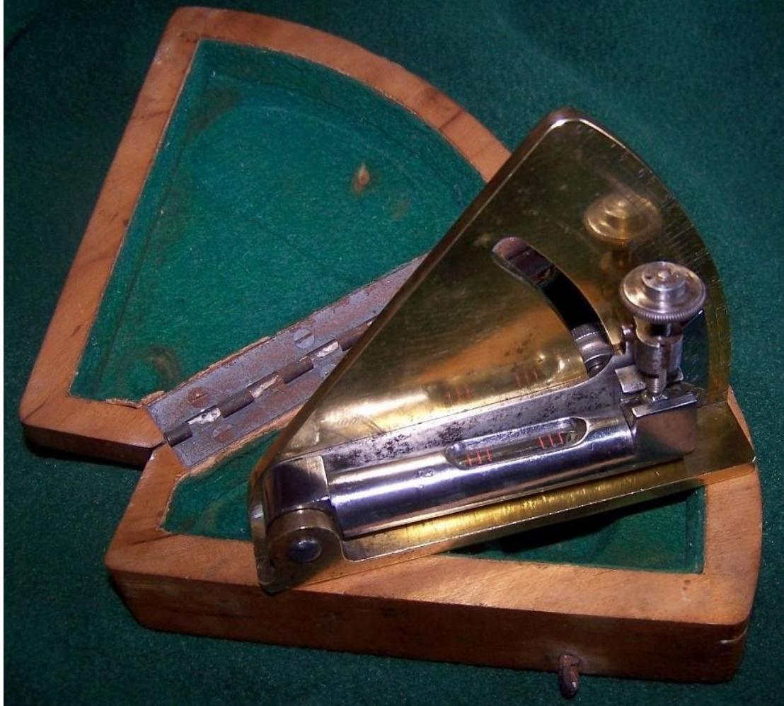
Simson "Clinometer" artilleri sigtemiddel til præcisionsskydning med kanoner
